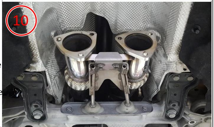
Befestigen Sie den Endschalldämpfer am Fahrzeug und verbinden Sie diesen wahlweise mit den WT Katalysatorrohren (11) oder den originalen Anschlussrohren mit der WT Downpipe (12). Nutzen Sie bei der Montage die originalen Dichtungen.
