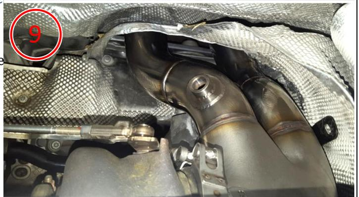
Montieren Sie die Kardanwelle und dessen Hitzeschutzblech. Verbinden Sie nun den unteren Halter der Downpipe mit dem Fahrzeug und der WT Downpipe (10).
